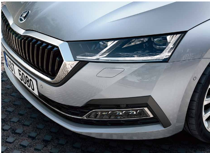
運用擋風玻璃攝影機，OCTAVIA COMBI 的 Matrix LED 智慧複眼頭燈組可以偵測前方或對向車輛自動調整遠光燈光束。提供最佳視線，又不會造成其他用路人目眩。
